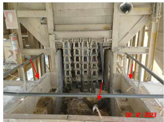
รูปที่ 6 ระบบสปร่น้ำภายในโรงโม่หิน
