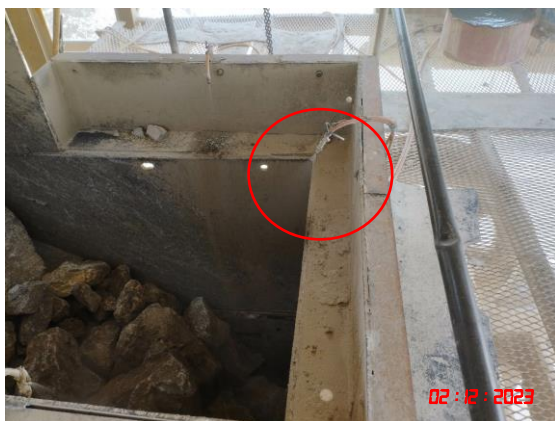
รูปที่ 6 ระบบสปร่น้ำภายในโรงโม่หิน
